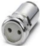
FL-WLAN 1100系列的附件：可选的电缆穿墙模块，用于密封 (IP67) FL-WLAN 110x接口 (IP20)，前提是设备没有直接整合到封闭的外壳上。安装在控制柜上时则不需要。
