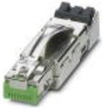
RJ45连接器，保护等级: IP20，位数: 8，1 Gbps，CAT5 (IEC 11801:2002)，标识材料: 锌压铸，接线方式: IDC 快速连接，接线容量: AWG 26- 24，电缆出口: 直头
